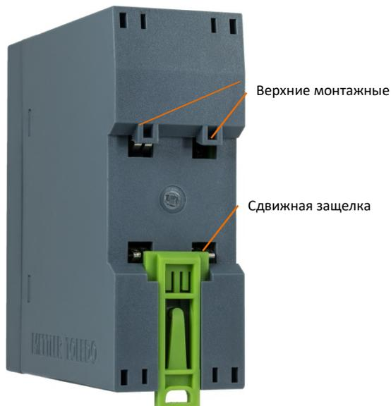
Для установки АСТ350 на рейку откройте защелку, оттянув ее вниз. Затем расположите прибор так, чтобы верхние петли встали на DIN-рейку.
