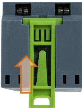
Чтобы снять АСТ350 с рейки, жалом отвертки нажмите на защелку и переместите ее вниз.
