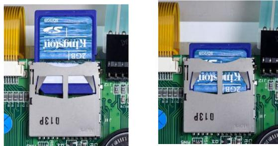
Figura A-72: Deslizar um cartão SD no soquete SD (esquerda); cartão SD instalado (direita)
