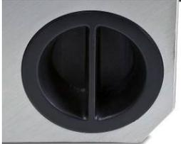
Instale a tampa da bateria alinhando suas guias com os slots dentro da cavidade da bateria – a alça será vertical. Quando ela for totalmente inserida, a tampa poderá ser alinhada com a parte externa do terminal.
