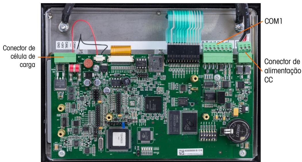
**Figura A-21: Conexão de Placa Principal do IND246 POWERCELL**
