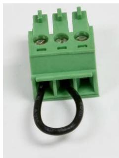
**Figura 5-11: Jumper entre os terminais COM1 de transmissão e recepção**
