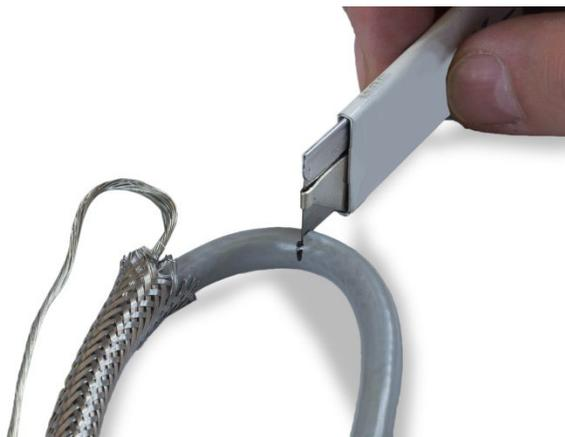
**Figura A-33:** Corte em torno da camisa do cabo.
