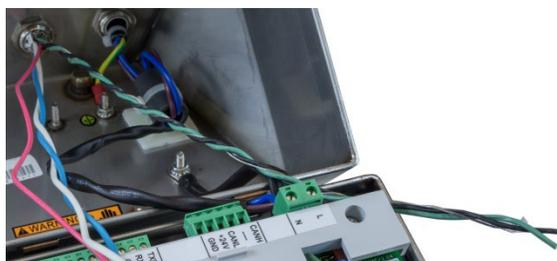
**Figura A-52: Fios de aterramento e fio de dreno interno torcidos juntos**
