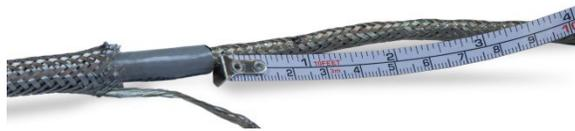
**Figura A-36: Marcando a blindagem trançada interna**
