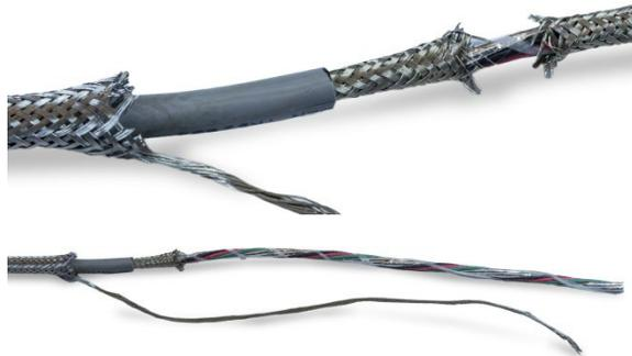
**Figura A-37: Removendo a blindagem trançada interna**
