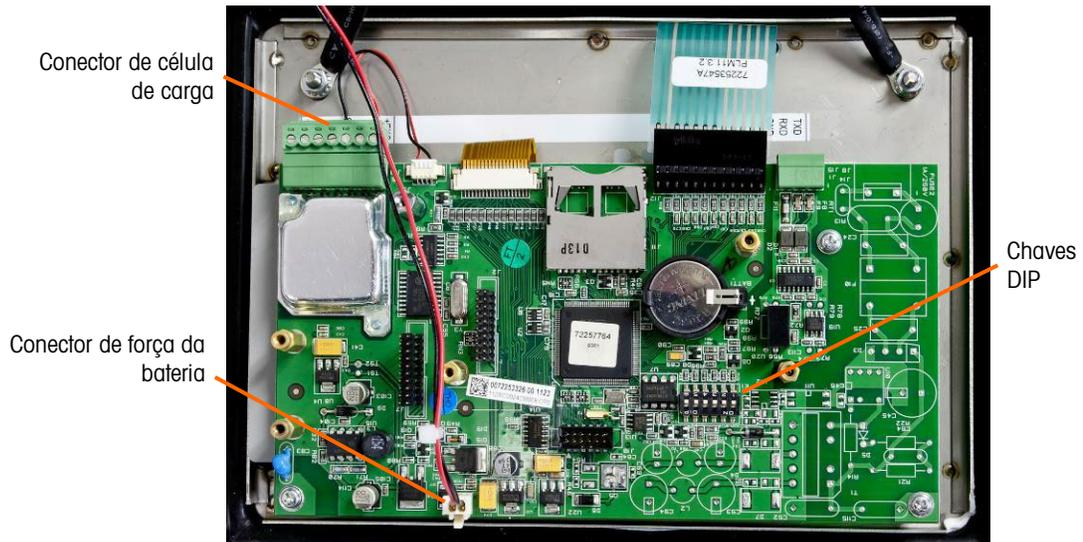
**Figura A-20: Conexão de Placa Principal do IND246, Modelo de Alimentação com Bateria**
