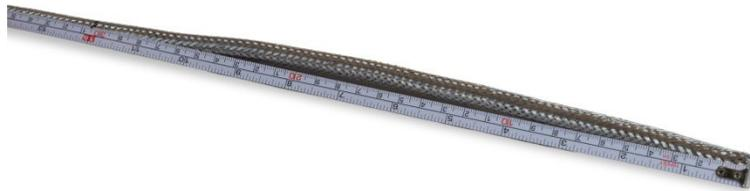
**Figura A-29: Medição de blindagem trançada externa antes do corte**
