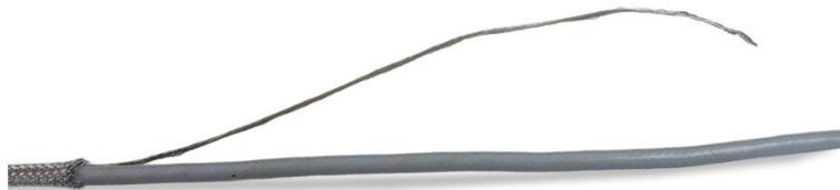
**Figura A-31: Parte posterior aparada da blindagem trançada externa**
