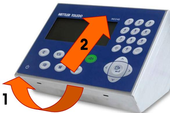
Figura A-2: Remoção da tampa
