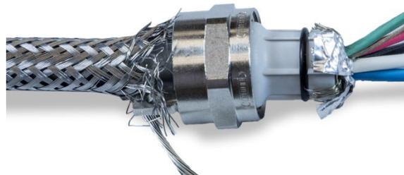
**Figura A-44: Fios blindados trançados internos e revestimento metálico aparado em toda da extensão e dobrado sobre o anel isolante.**
