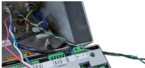
**Figura A-52: fili di messa a terra e di scarico interno ritorti**
