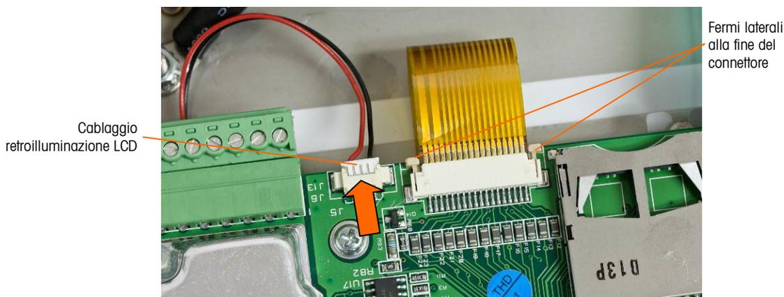
**Figura 5-18: Rimozione cablaggio del display**
