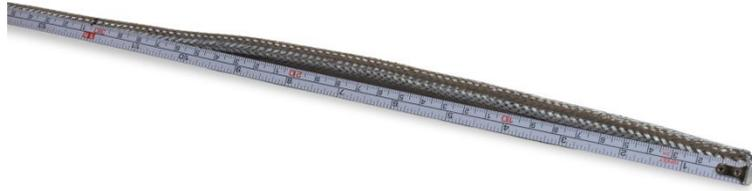
**Figura A-29: schermatura intrecciata esterna tagliata con filo di scarico esterno a vista**
