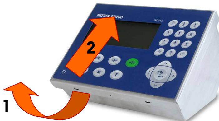
Figura A-2: Rimozione del coperchio
