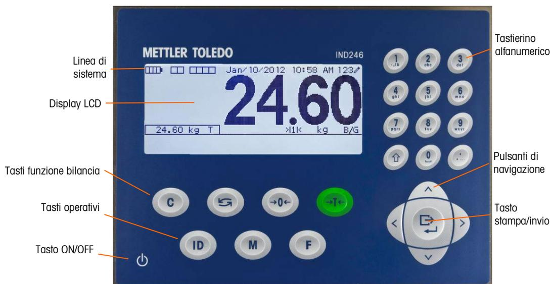
Figura 1-5: Layout del pannello anteriore di IND246
