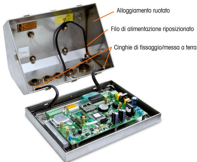
**Figura A-5: Alloggiamento invertito**
