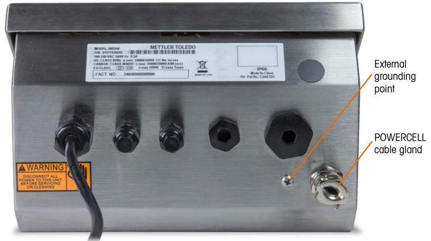
**Figura A-27: I Alloggiamento dell'IND246 POWERCELL con pressacavo del cavo POWERCELL e punto di messa a terra**
