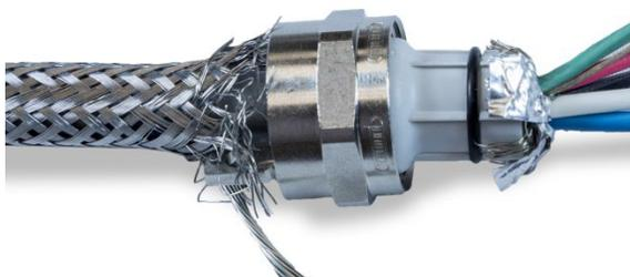
**Figura A-44: schermatura intrecciata interna e foglio di alluminio tagliati e ripiegati sull'occhiello**
