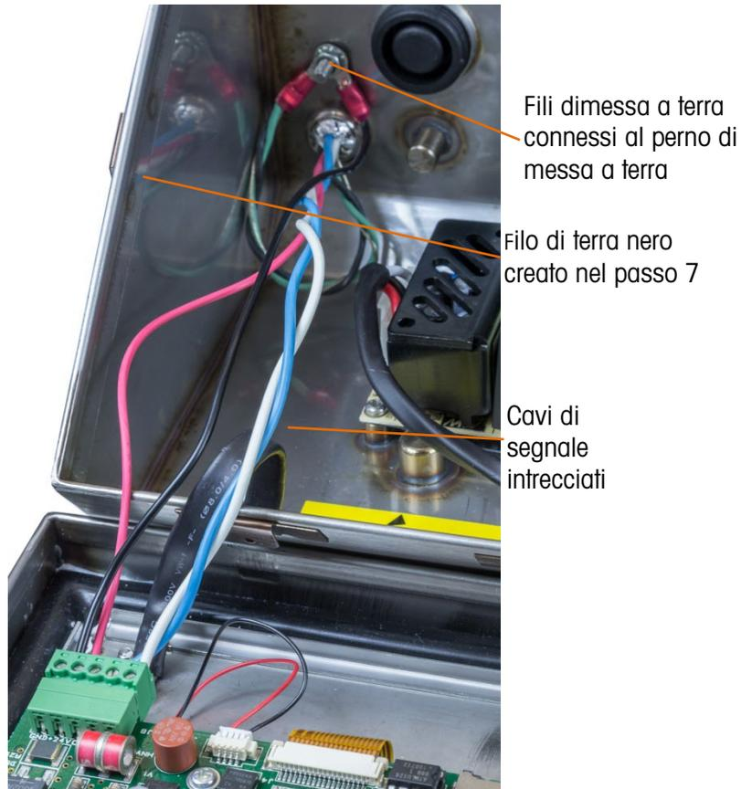
**Figura A-55: cablaggio interno POWERCELL completato**
