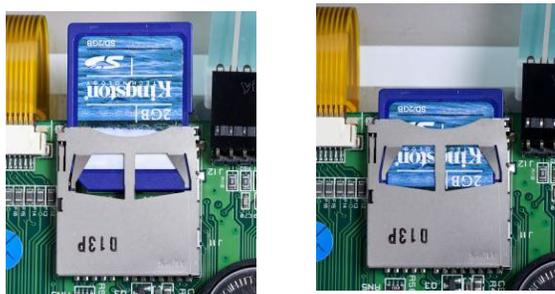
**Figura A-73: Inserimento di una scheda SD nella presa SD (sinistra); scheda SD installata (destra)**
