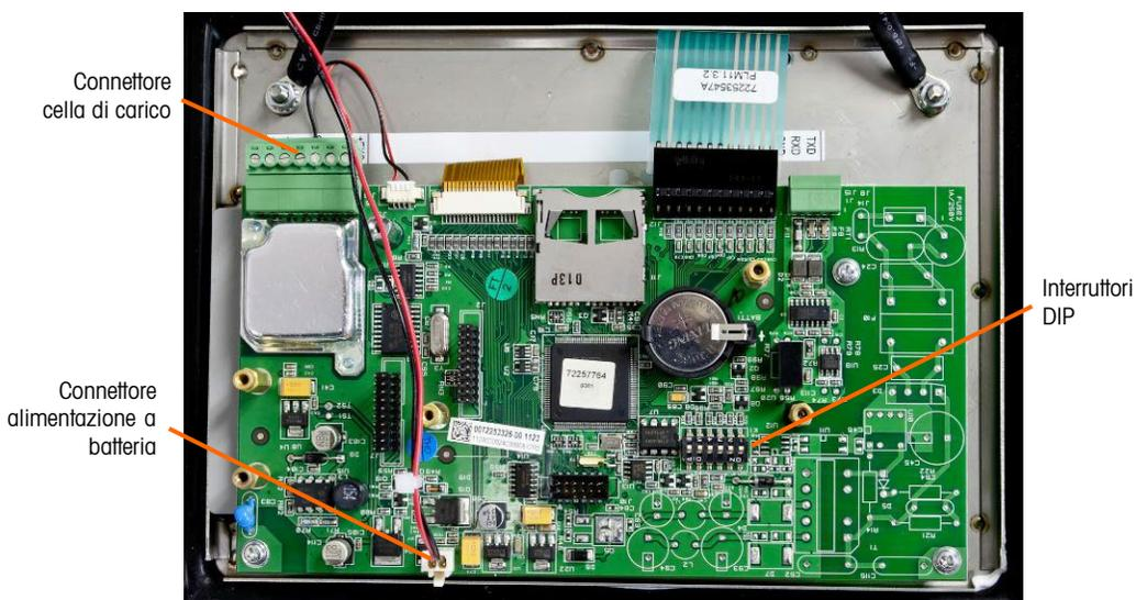
Figura A-20: Collegamenti scheda madre IND246, modello a batteria
