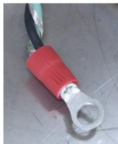
**Figura A-53: terminazione del cavo di messa a terra**
