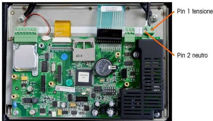
**Figura 5-5: Posizione pin per test di alimentazione CA, versione analogica**
