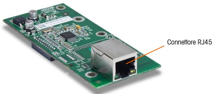
**Figura A-60: Scheda opzionale connessione Ethernet**
