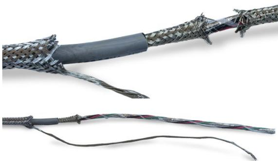
**Figura A-37: rimozione della schermatura intrecciata interna**
