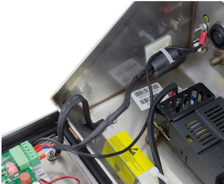
Figura A-56: Connettore PowerDeck installato nell'IND246 POWERCELL
