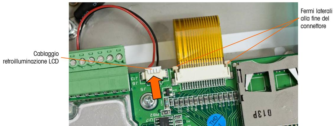
**Figura 5-13: Rimozione cablaggio del display**
