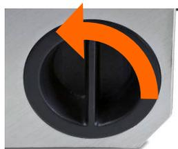
Il coperchio circolare della batteria si trova sul lato destro del terminale. Ruotare il coperchio di  $\frac{1}{4}$  di giro in senso antiorario, fino a che la maniglia non sia in posizione verticale.
