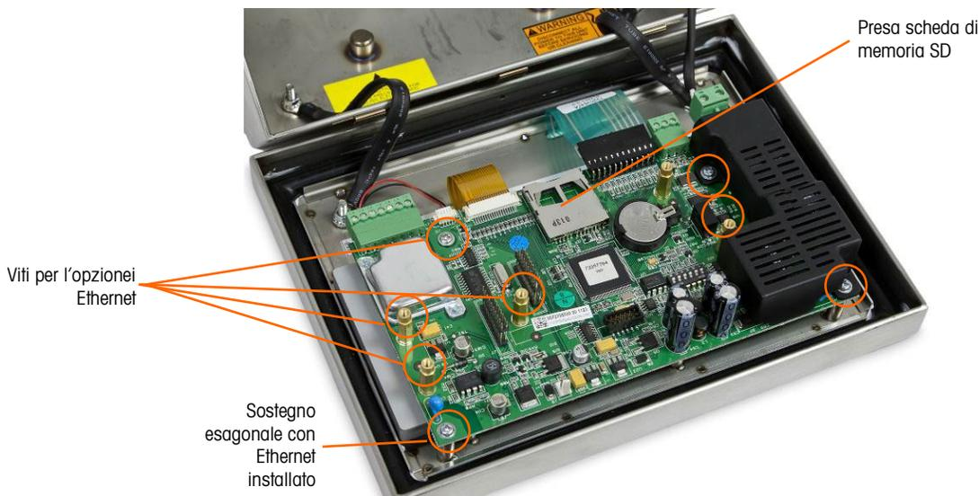
**Figura 5-14: Montaggio viti per scheda madre, versione analogica**
