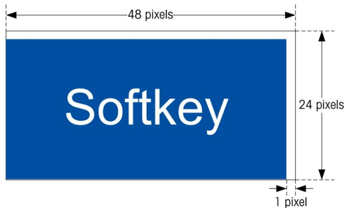
图 3-12：软键图形尺寸
