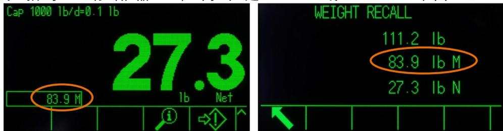
图 2-15 在负净重修正允许时的皮重显示
