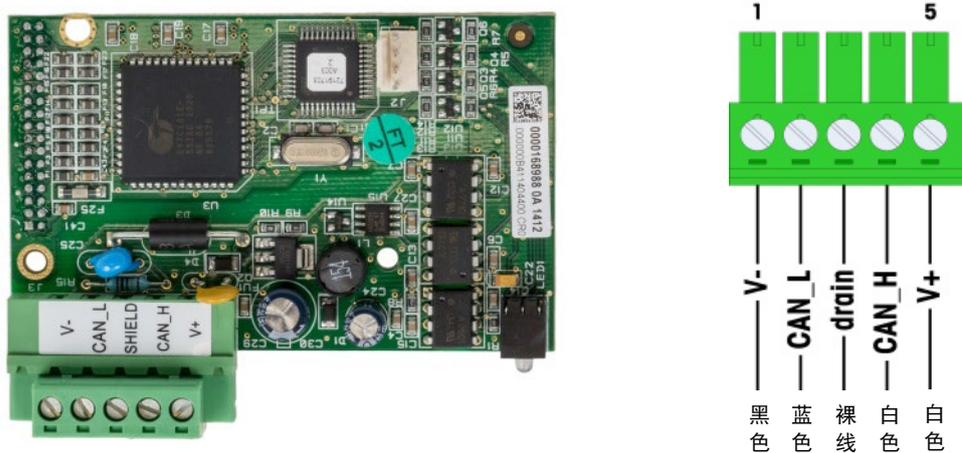
图 A-51 DeviceNet PLC 选件板和接线
