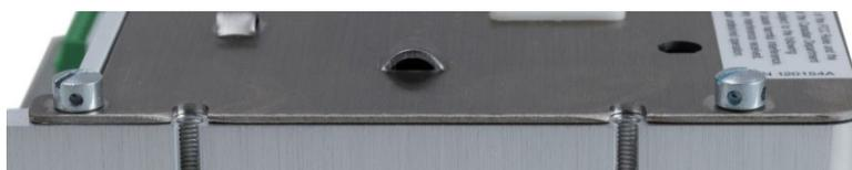
图 A-67 安装了铅封螺丝
