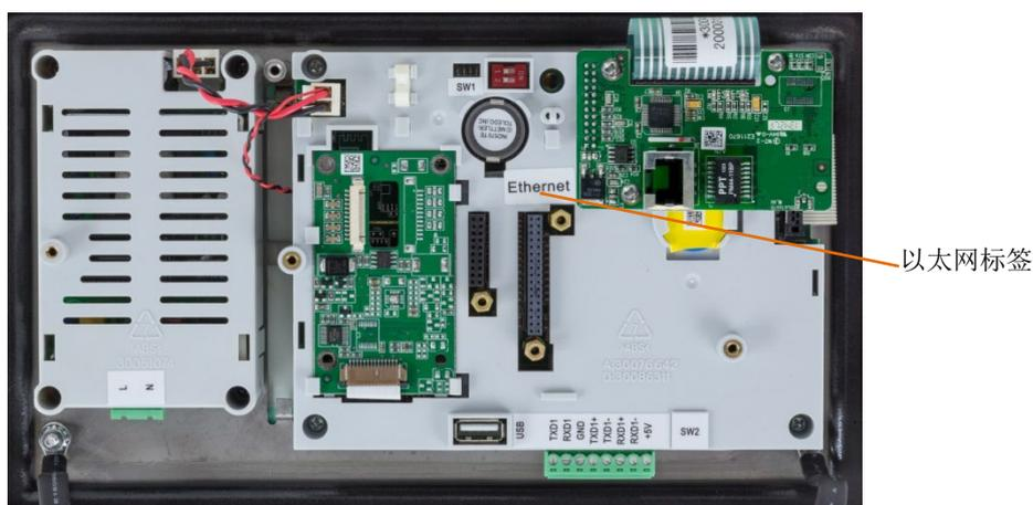
图 A-39 主板上安装的以太网选件板
