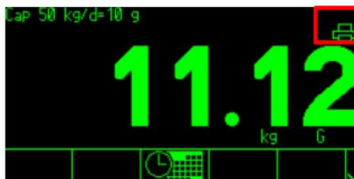
图 D-5 系统行中的打印机连接状态
