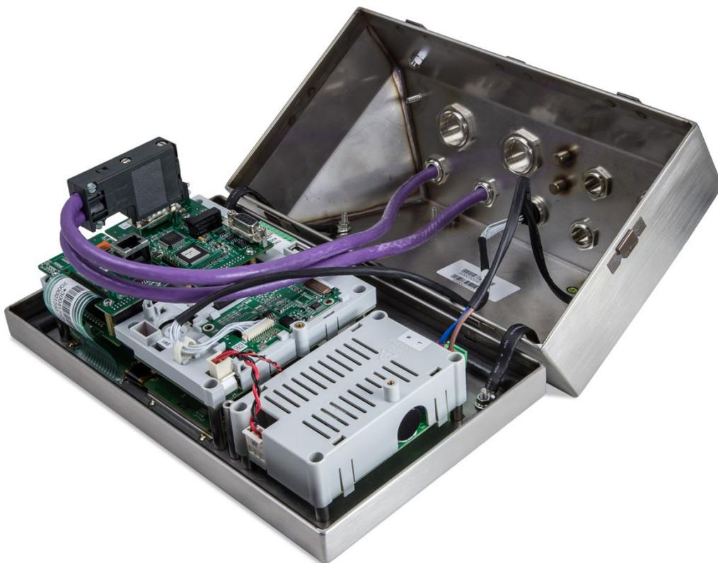
图 A-55 防尘式 Profibus 电缆连接
