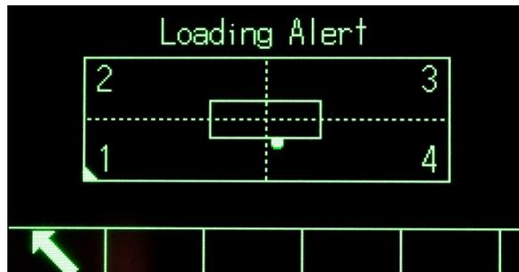
加载警告提示界面如上图，1/2/3/4 四个数字表示 4 个传感器位置。当被称物体的重心不在设定区域内时，将会图形化显示这一界面并有一个小点指示当前物体重心位置在哪。操作人员可以根据这一提示向导移动物体到指定位置。
