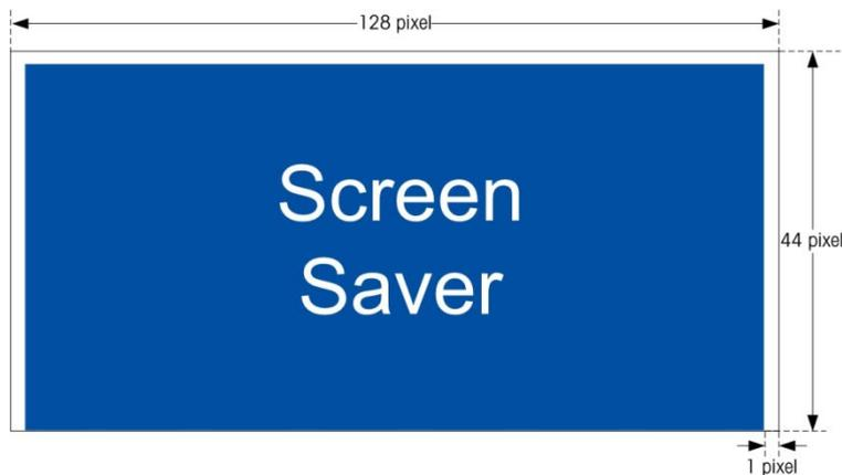
图 3-8：屏幕保护图片尺寸
