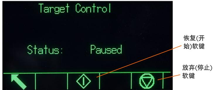
图 2-19 目标值控制中“已暂停”状态的示例
