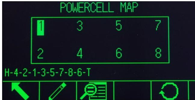
图 3-18: 完成后的 POWERCELL 节点映射图
