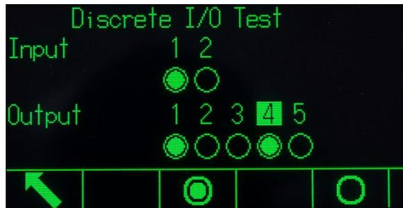
图 5-17: 离散 I/O 测试窗口
