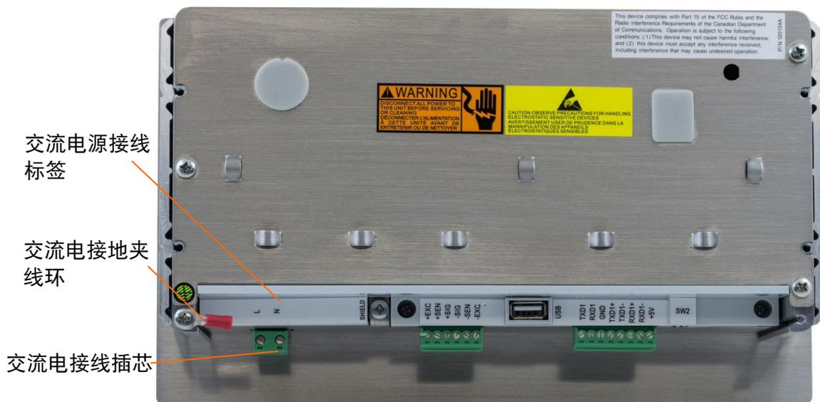
图 A-25 面板式上的交流电连接
