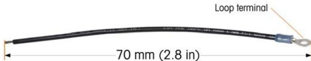
3. 将传感器电缆穿过仪表上提供的压线环，并进行接地，按如下方式进行安装
