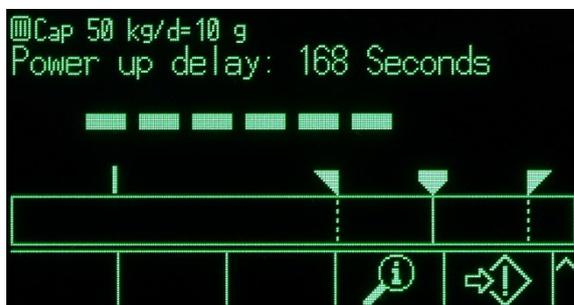
图 3-6：系统信息行显示开机延时
