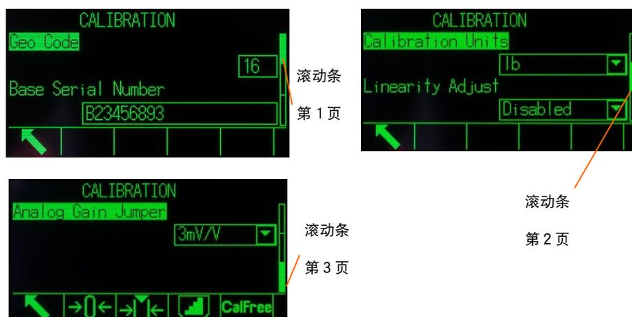
图 2-6 滚动条的示例，指示三页的配置字段
