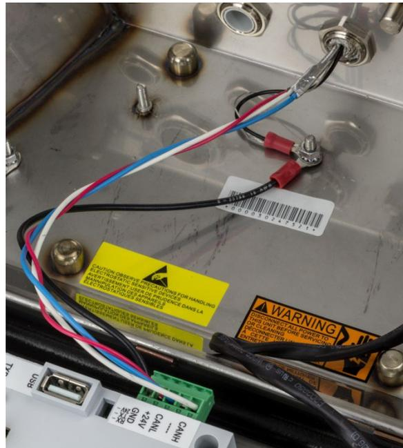
图 A-30 线缆接入仪表插芯完成内部接线
