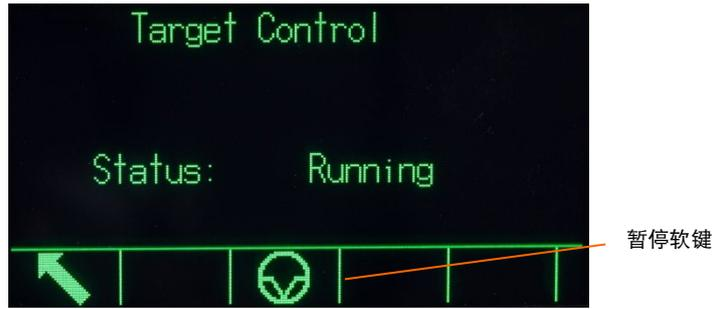
图 2-18 目标值控制中“正在运行”状态的示例
