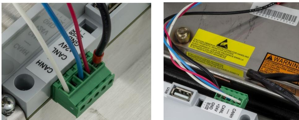
图 A-34 POWERCELL 接线插芯的链接
