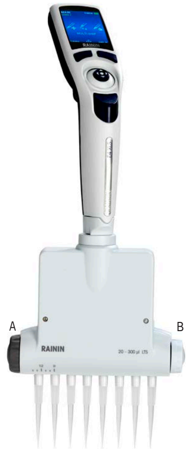
図 34 : E4 XLS のアジャスタブルスパーサー A : 間隔調整 B : リミッター
