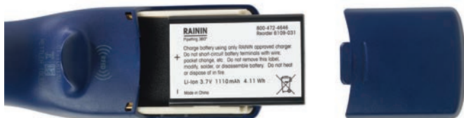
図 5：メインバッテリーの取り付け
