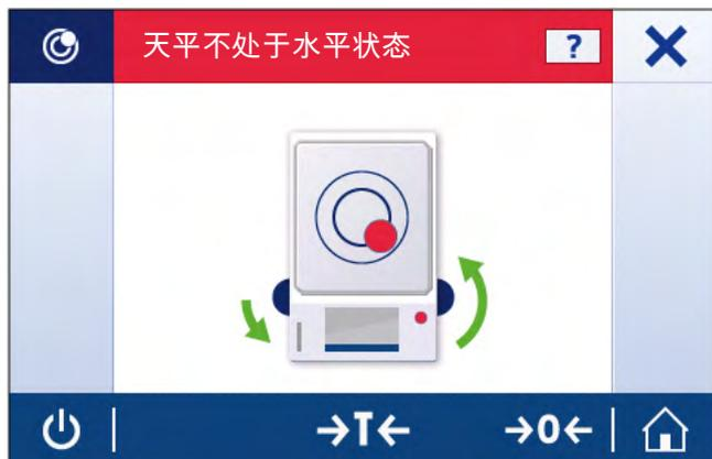
执行指令后，水平调节助手将继续执行下一步骤。按照步骤进行操作，直至调平天平。
