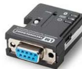
Envíe datos de la balanza a un PC, una tableta o una impresora de forma inalámbrica. No se necesita software adicional.
